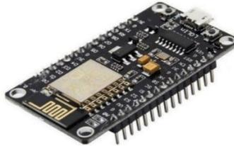
Gambar 4, NodeMCU ESP8266.
