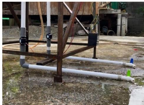
Gambar 7. Rangkaian pipa outlet dan generator piko hidro
