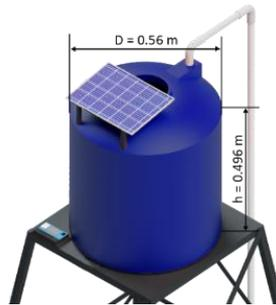
Gambar 2. Rancangan peletakan panel surya pada tangki air
